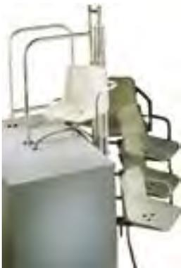
Se compone de una estructura en tubo Ø 43 mm de acero inoxidable AISI-316 acabado pulido brillante en la que se adapta el mecanismo hidráulico donde se soporta el asiento y lateralmente una escalera válida para el monitor. Para que el mecanismo hidráulico funcione, es necesario una toma de agua de la red con una presión mínima de 3,5 kg/cm<sup>2</sup>.
